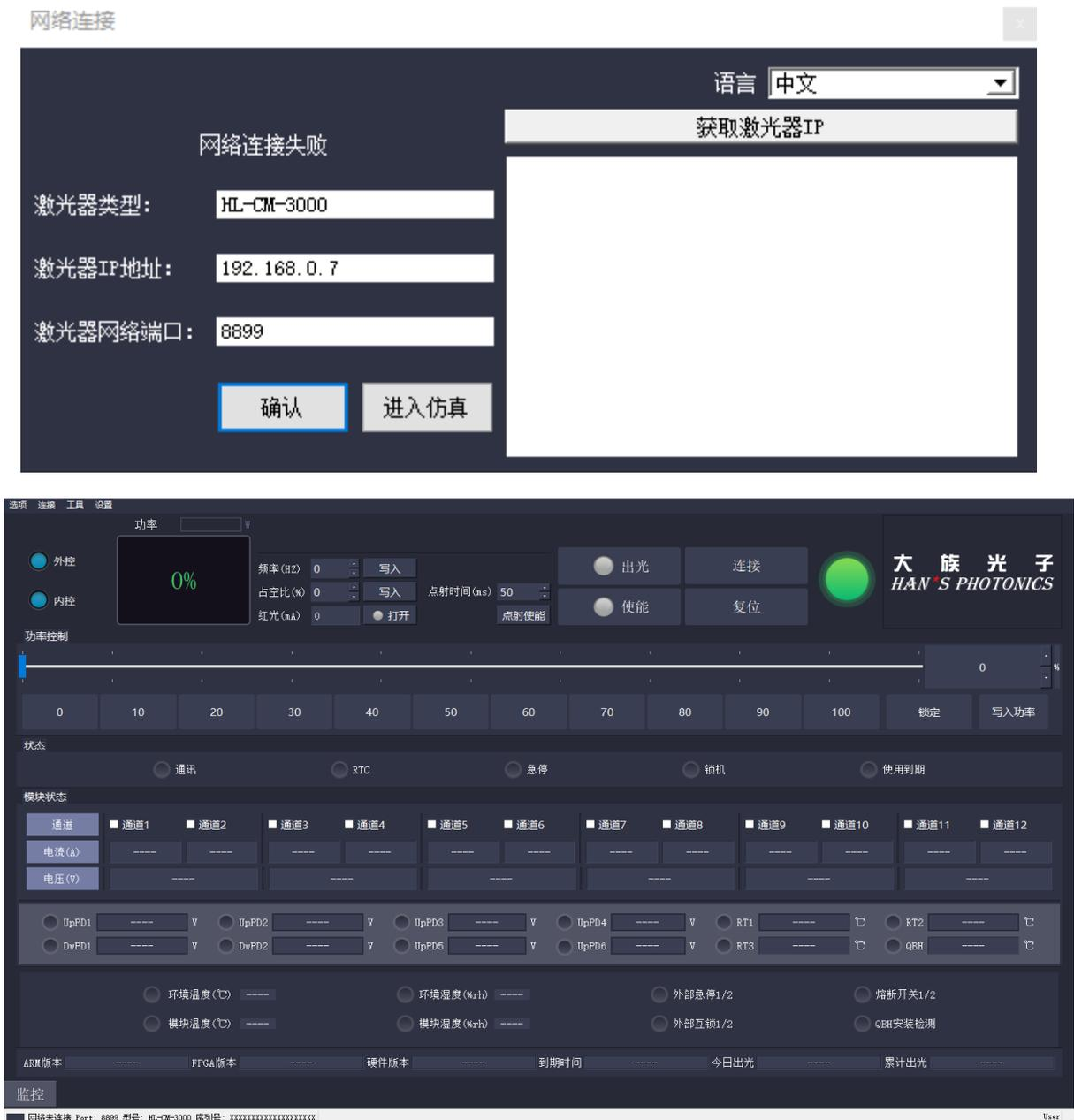
2、对装有操作界面的本地电脑需要进行如下设置：IP地址：192.168.0.xxx（xxx不能设置为激光器的IP地址）；子码掩码：255.255.255.0；默认网关：192.168.0.1
